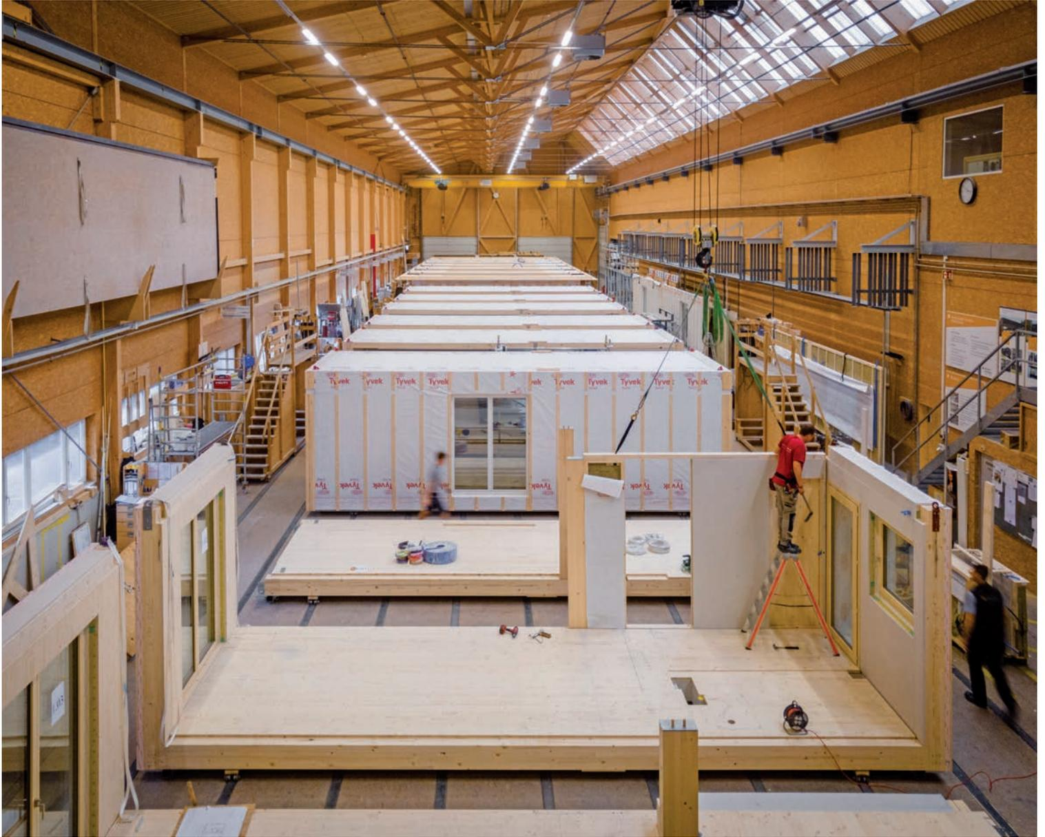
Das modulare Bauen aus Holz gewährleistet eine hohe Ausführungsqualität. Die Montage im Werk erfolgt witterungsunabhängig bis hin zum Innenausbau.
