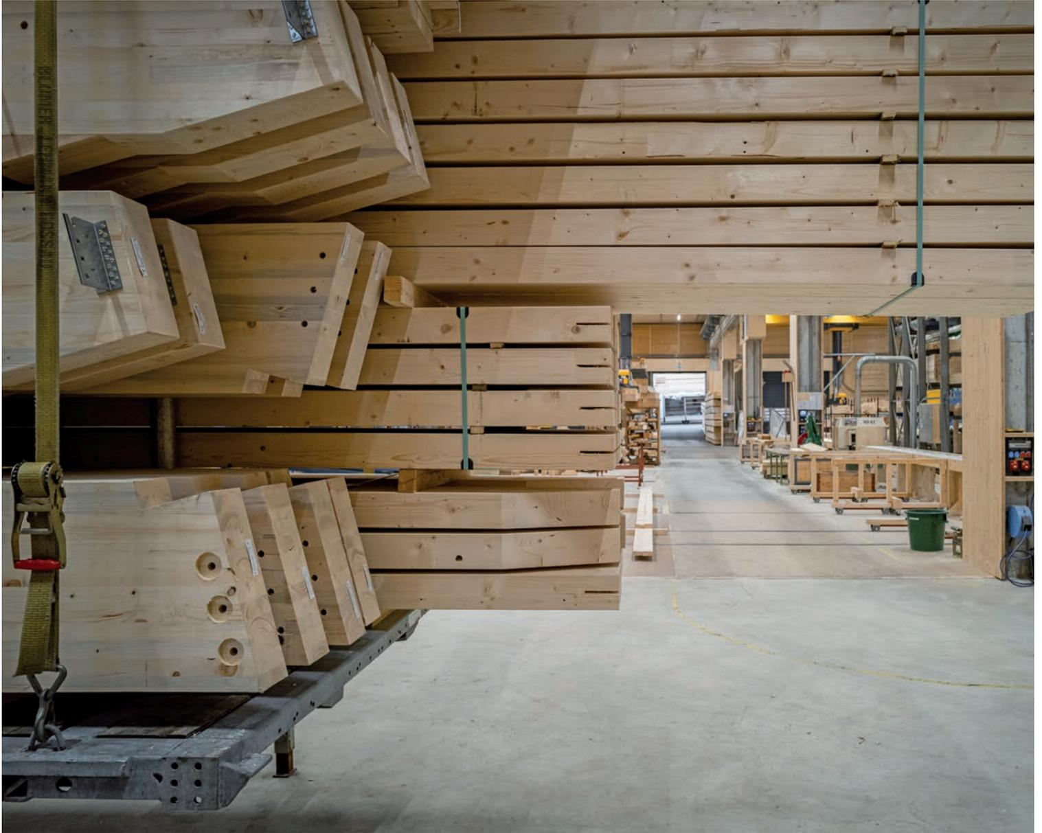
Die Holzbau-Elemente oder Bauteile werden im Werk vorgefertigt, um anschliessend vor Ort zügig zusammengesetzt werden zu können.
